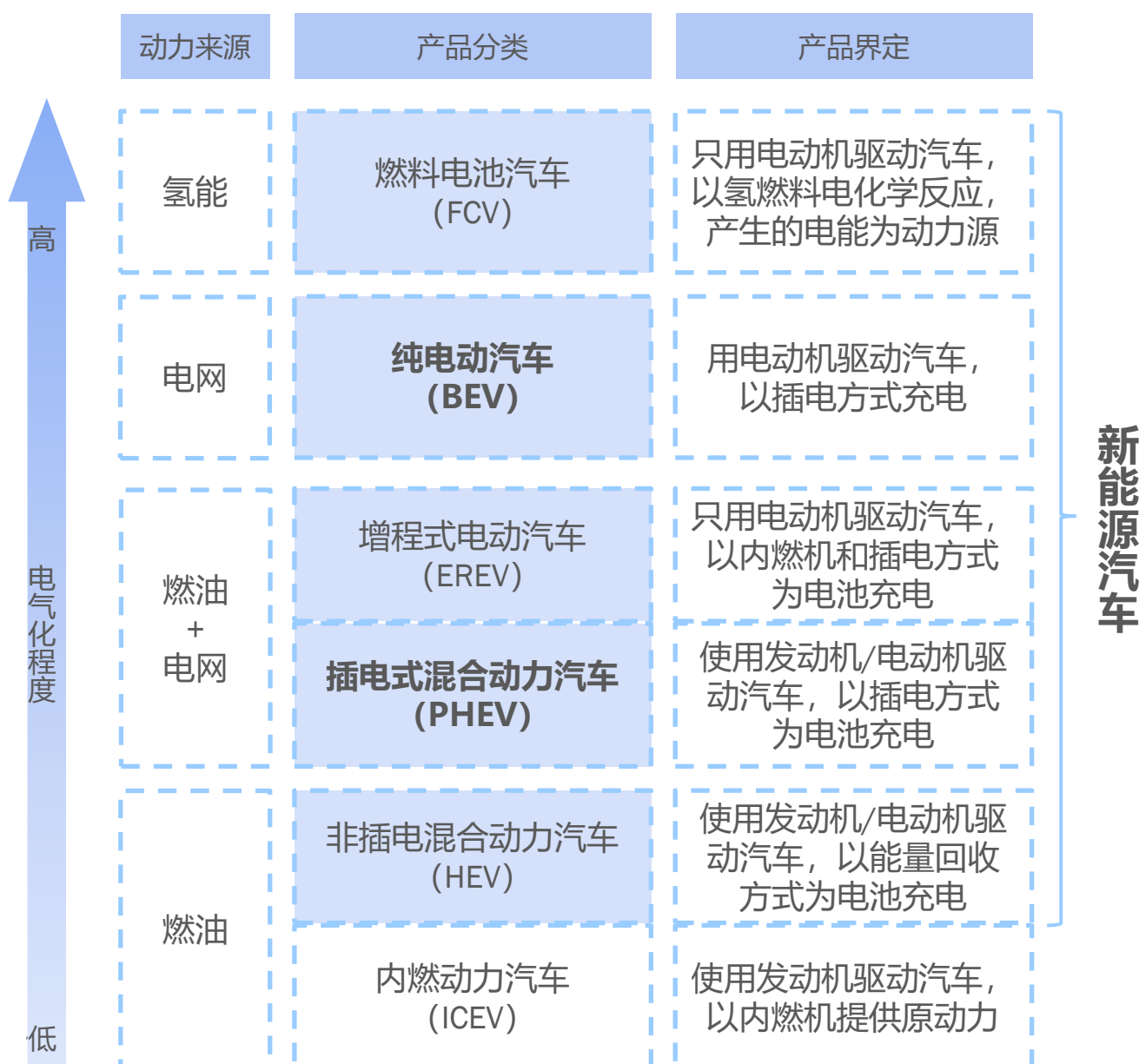
图示：按照电气化程度区分汽车品类
